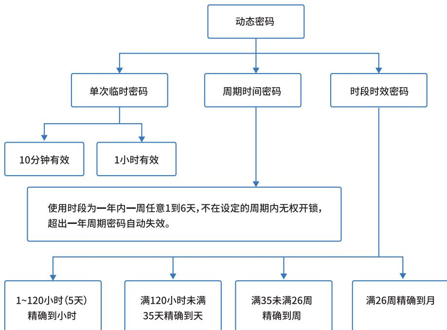
进入主菜单界面，在主菜单界面中选择“锁模式”，按“#”键确认，系统设置界面中选择“动态密码”，屏幕会显示“单次临时密码、周期临时密码、时段时效密码”，在选择你想要启用的动态密码菜单中的“单次临时密码”，按“#”键确认，然后根据实际使用情况设置“单次临时密码、周期临时密码、时段时效密码”，最后按“#”键确认，完成设置后，按“\*\*”返回。
