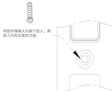
4. 安装方轴时一定要将把手弹簧放入后锁体内, 弹簧的大头一定要朝下, 否则弹簧会卡住, 导致开门异常。(后锁面的方轴选取, 插入锁体, 高于门平面 25-35mm, 只有后锁面才需要放弹簧, 前锁面不需要放弹簧)。
